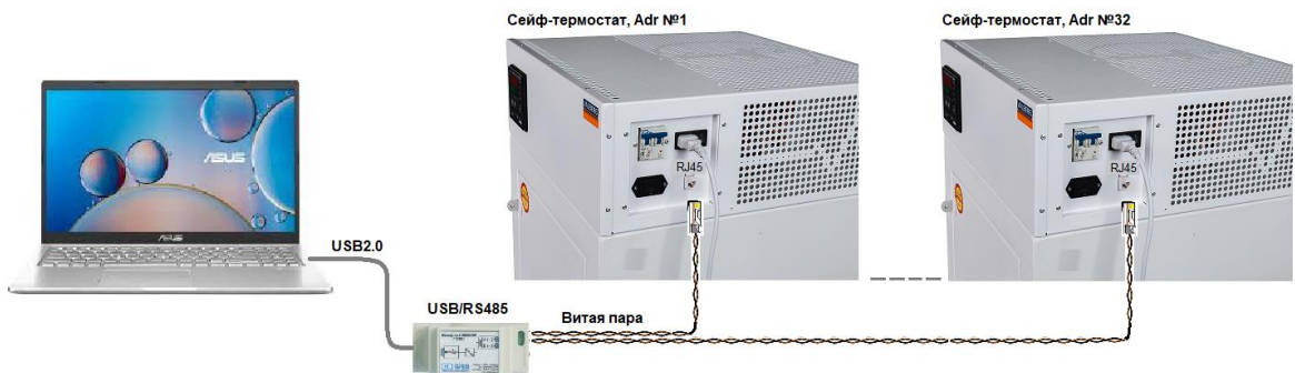
Рис. 8. Подключение интерфейса сейфов-термостатов к ПК
