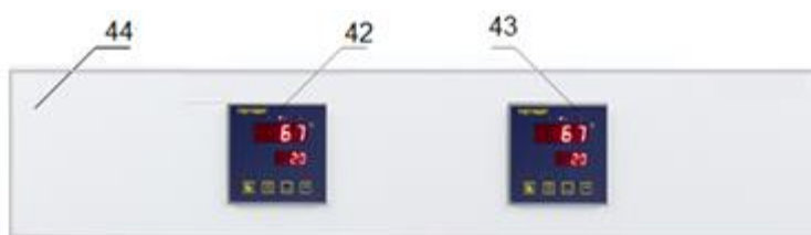
Рис. 8. Блок управления сейфа-термостата
